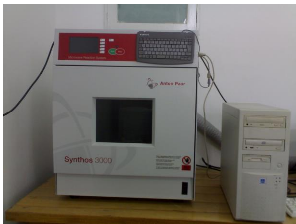
Figura 1. Poza unui reactor cu microunde profesionist si a tancului de probe (Facultatea de Chimie, Universitatea "Babes-Bolyai" Cluj-Napoca)
