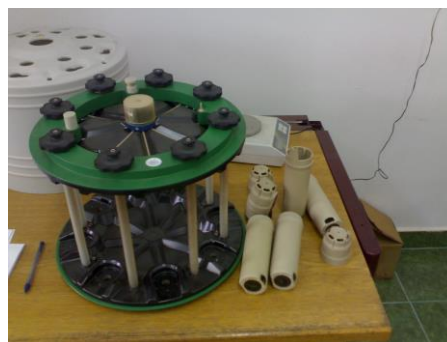
Figura 1. Poza unui reactor cu microunde profesionist si a tancului de probe (Facultatea de Chimie, Universitatea "Babes-Bolyai" Cluj-Napoca)
